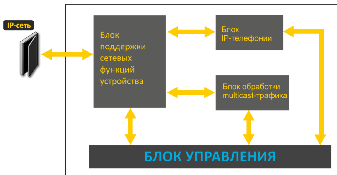
Рисунок 3 – Функциональная схема устройства серии TAU-4M.IP
