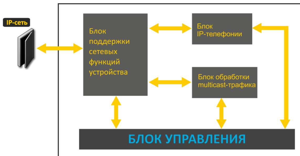
Рисунок 3 – Функциональная схема устройства серии TAU-1M.IP
