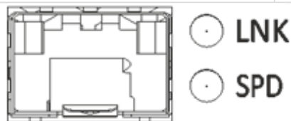
Рисунок 15 – Расположение индикаторов разъема SFP
