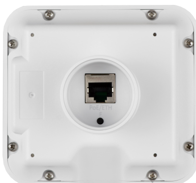
Рисунок 7 — Разъем RJ-45 и функциональная кнопка «F»
