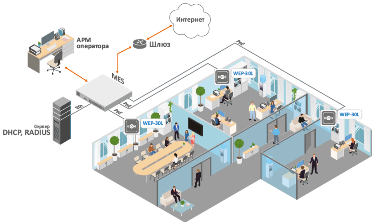
Рисунок 1 — Функциональная схема использования WEP-30L
