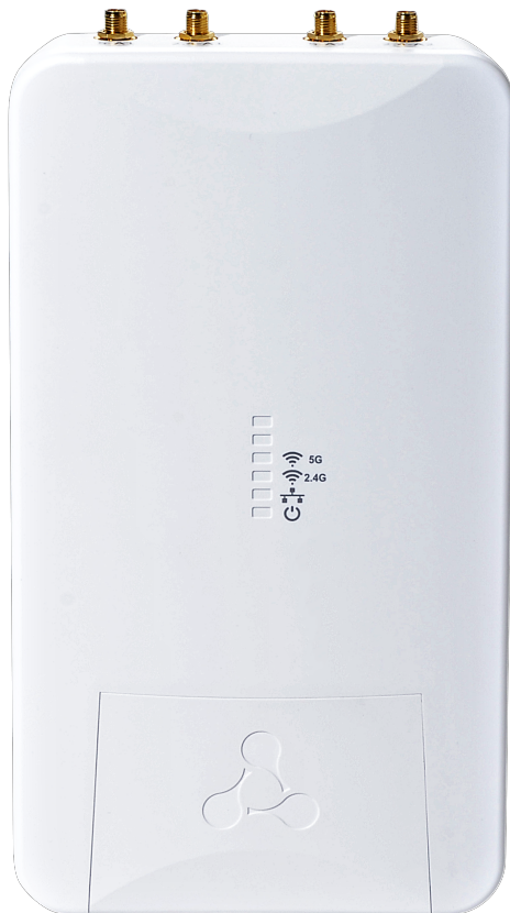
Рисунок 2 – Внешний вид основной панели WOP-20L
