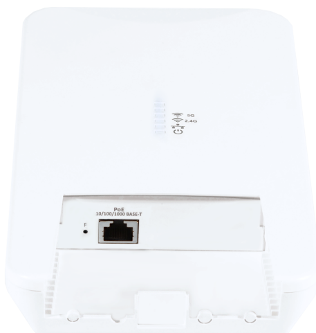
Рисунок 3 – Внешний вид нижней панели WOP-20L
