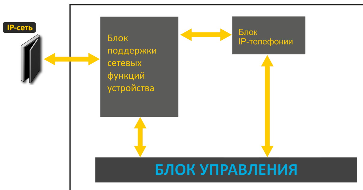
Рисунок 3 — Схема включения TAU-8N.IP
