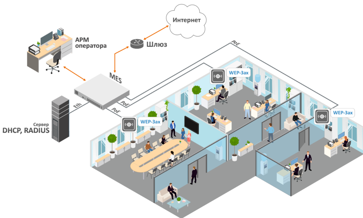
Рисунок 1 – Функциональная схема использования WEP-3ax, WEP-3ax-Z
